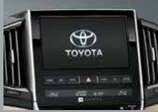
شاشة عرض EMVN (رؤية متعددة كهربائية مع توجيه ملاحي) مقاس 9 بوصات 9-inch EMVN (Electro Multi Vision with Navigation) display
